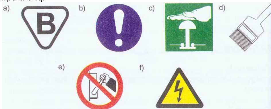
Rys. 8. Znaki występujące na urządzeniach mechanicznych: a) bezpieczeństwa, b) ogólny znak nakazu, c) zatrzymanie awaryjne, d) usuwanie wiórów, e) zakaz uruchamiania maszyny, urządzenia, f) ostrzeżenie przed porażeniem prądem elektrycznym [15, s. 44]
