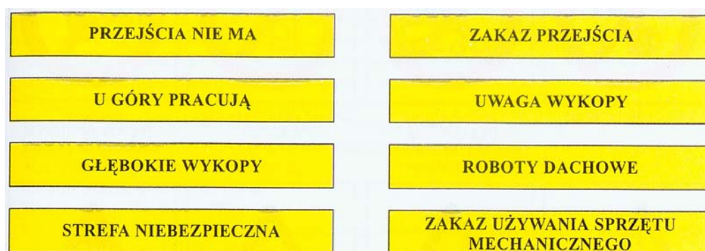
Rys. 2. Przykładowe tablice informacyjne i ostrzegawcze na budowie [5, s. 127]
