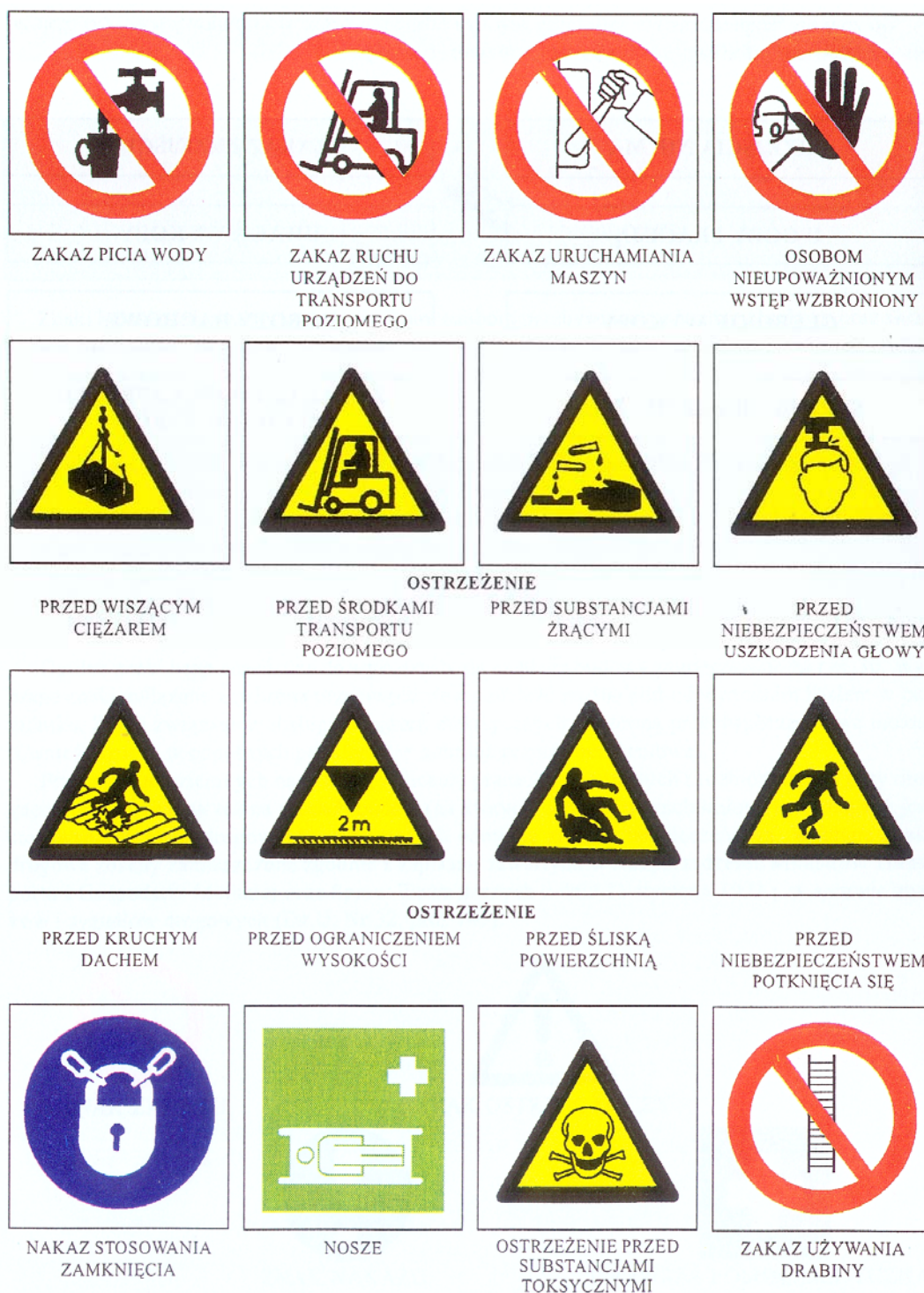
Rys. 4. Przykłady stosowanych na budowie znaków bezpieczeństwa [5, s. 128]
